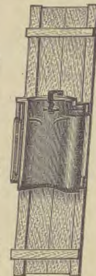
Laat de pannen op uw dak bevestigen met onze W. B. PATENT PANKLEMMEN NEDERLANDSCH OCTROOI No. 25592 GEBR. BODEGRAVEN, NIEUWKOOP, Tel. 4
